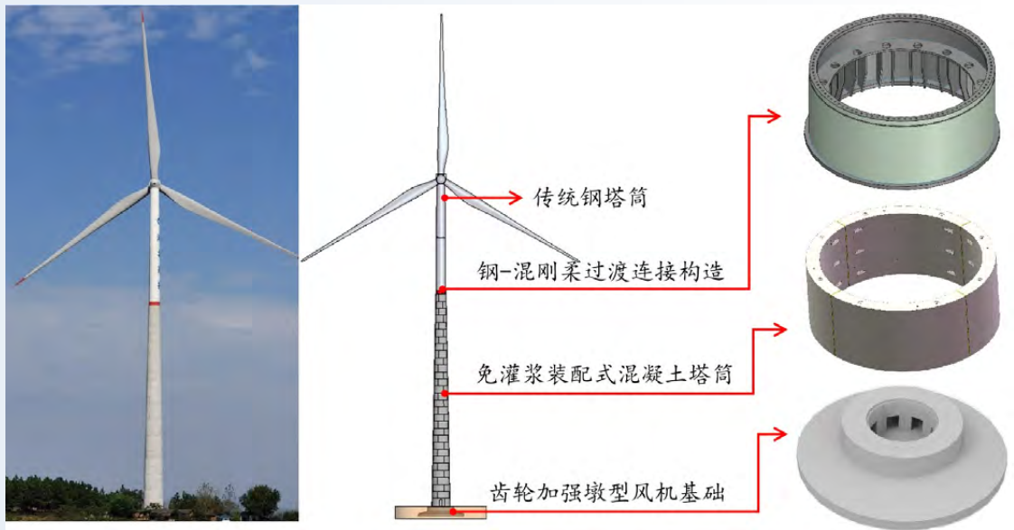
免灌浆装配式钢-混凝土混合结构风电塔筒
