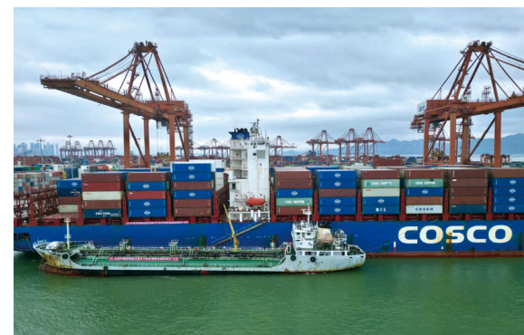
图9.4 广州港实施生物燃油加注作业（左）“远拖一”轮在大连港加注氨（右）
