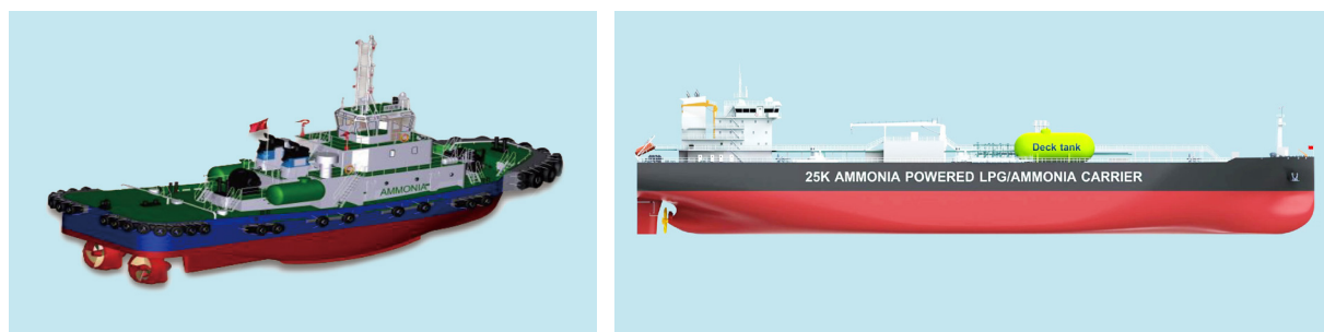
图6.3.1 中远海运5500 HP 氨燃料港作拖轮（左）和西南海运25000方氨运输船（右）
